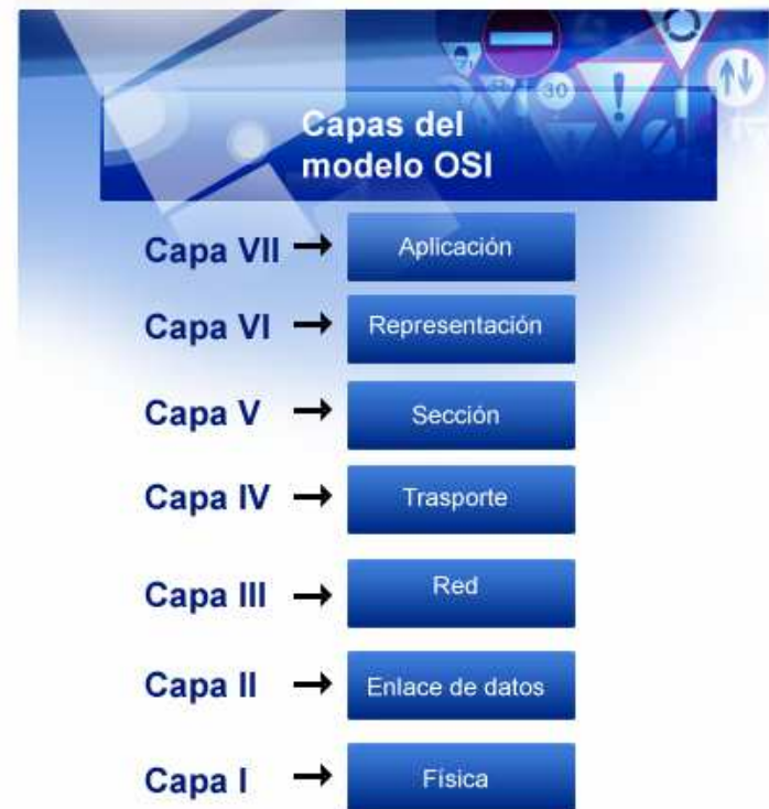
Gráfico I.6. Capas del modelo OSI.
